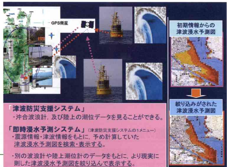
図4 津波防災支援システムと即時浸水予測システム
