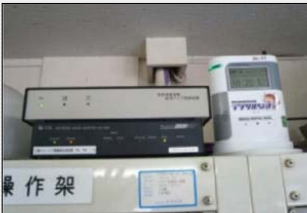
緊急地震速報装置（「デジタルなまず」）
