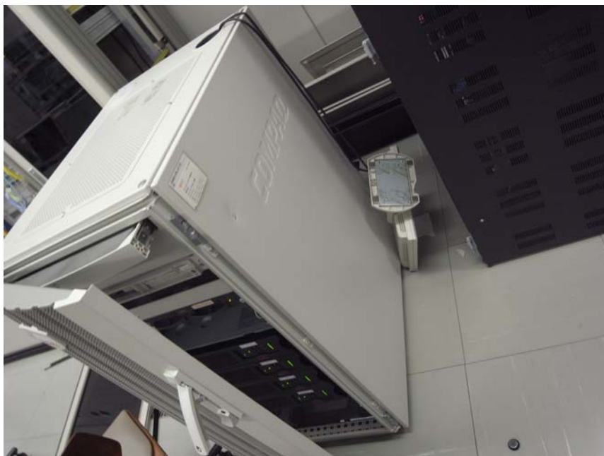
【計算機室】事務システムサーバラック モニタ破損・液晶漏れ
