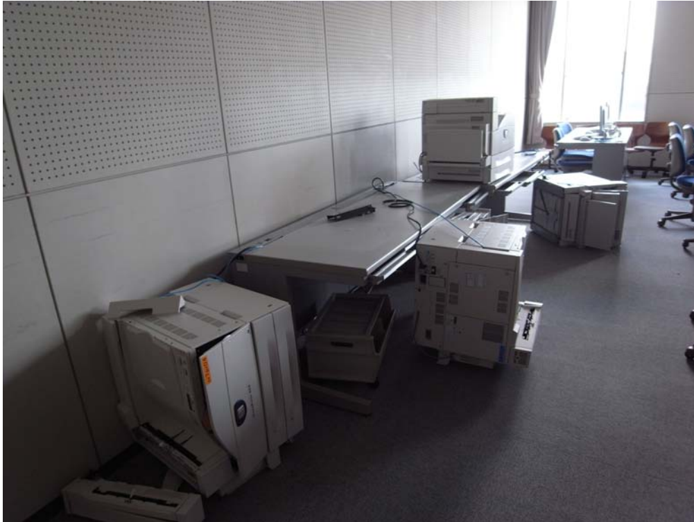
【第7コンピュータ室】プリンタ3台落下・破損
